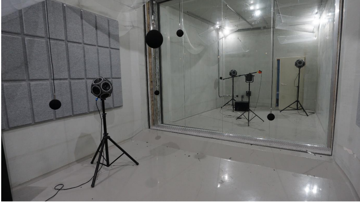
Şekil 5.1 Alıcı Odada Ölçüm Süreci
