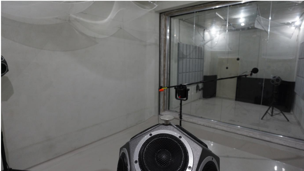
Şekil 5.2 Kaynak Odada Ölçüm Süreci
